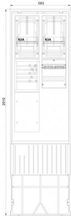
**Zähleranschlusssäule 2-feldrig, H=2010mm, 2-3.HZ,
