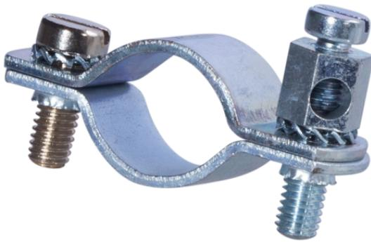
ERS1/4; 1/4" (13-15 mm) mit Anschlussklemme; Erdungsrohrscheiden; Material: Kupfer, vernickelt
