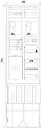
**Zähleranschluss säule 2-feldrig, H=2010mm, 2-eHZ,
