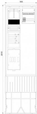
**Zähleranschlusssäule 2-feldrig, H=2010mm, 3.HZ,
