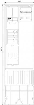
**Zähleranschluss säule 2-feldrig, H=2010mm, 3.HZ,
