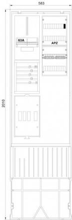
**Zähleranschluss säule 2-feldrig, H=2010mm, 3.HZ,
