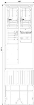
**Zähleranschlusssäule 2-feldrig, H=2010mm, 2-3.HZ,
