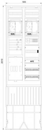
**Zähleranschlussssäule 2-feldrig, H=2010mm, eHZ,
