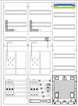
**Zählerfeld 3-feldrig, H=1050mm, 3-3.HZ 16mm<sup>2</sup>, 3 ZSK-Set, 3 HSP, Z31B-16-ZSK-HSP**
