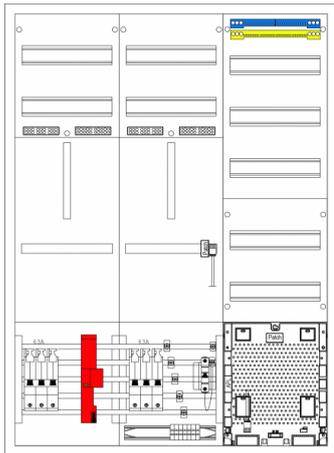
**Zählerfeld 3-feldrig, H=1350mm, 5-3.HZ,5 ZSK-Set, 5 HSS,1 Res., Z216ZR6-ZSK-HSS**
