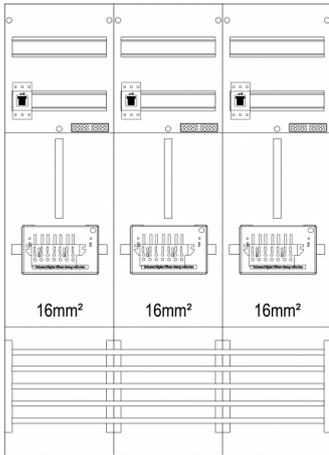
**Zählerfeld 3-feldrig, H=1050mm, 3-3.HZ 16mm<sup>2</sup>, 3 ZSK-Set, 3 HSS, Z31B-16-ZSK-HSS**
