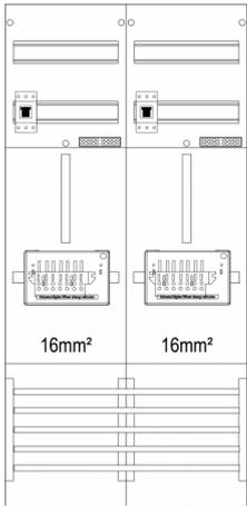
**Zählerfeld 2-feldrig, H=1050mm, 2-3.HZ 16mm<sup>2</sup>, 2 ZSK-Set, 2 HSP, Z21B-16-ZSK-HSP**
