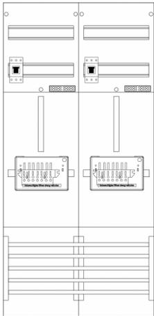
**Zählerfeld 2-feldrig, H=1050mm, 2-3.HZ, 2 ZSK-Set, 2 HSP, Z21B-ZSK-HSP**
