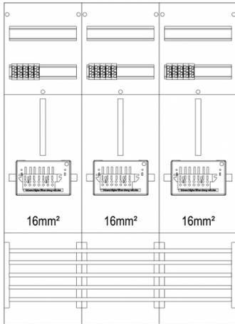
**Zählerfeld 3-feldrig, H=1050mm, 3-3.HZ 16mm<sup>2</sup>, 3 ZSK-Set, Z31B-16-ZSK**
