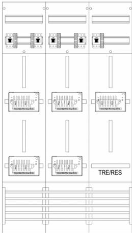
**Zählerfeld 3-feldrig, H=1350mm, 5-3.HZ, 5 ZSK-Set, 5 HSS, 1 Res., Z216ZR6-ZSK-HSS**
