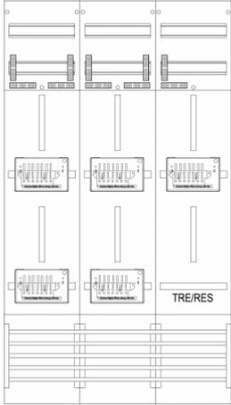
**Zählerfeld 3-feldrig, H=1350mm, 5-3.HZ, 5 ZSK-Set, 1 Res., Z216ZR6-ZSK**
