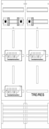
**Zählerfeld 2-feldrig, H=1350mm, 3-3.HZ,3 ZSK-Set, 3 HSS, 1 Res, Z16ZR6-ZSK-HSS**
