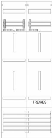
**Zähleranschlusssäule 2-feldrig, H=2010mm, 2-3.HZ,
