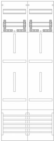
**Zähleranschluss säule 2-feldrig, H=2010mm, 2-3.HZ,
