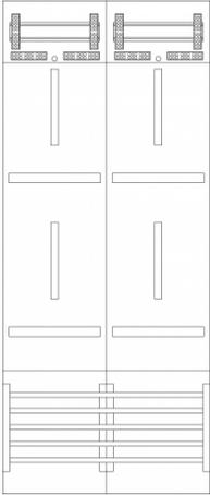
**Zähleranschlusssäule 2-feldrig, H=2010mm, 2-3.HZ,
