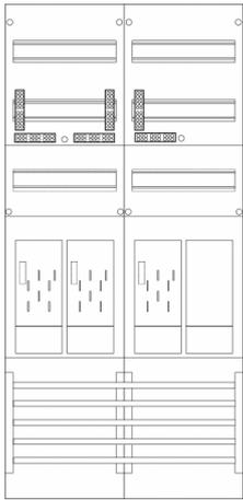
**Zähleranschluss säule 2-feldrig, H=1710mm, eHZ,
