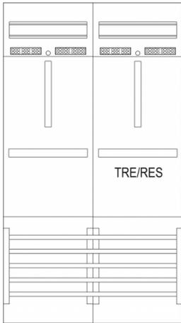
**Zähleranschluss säule 2-feldrig, H=2010mm, 2-3.HZ,
