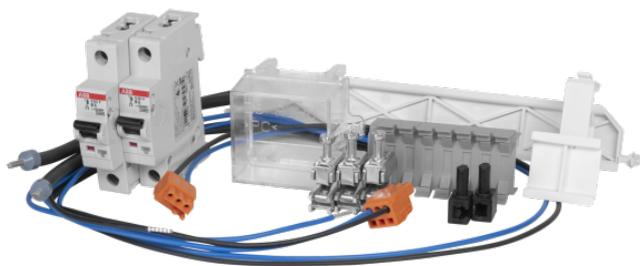
Absicherungspaket TIIEHZ. Besthet aus: 2x LS-Schalter B6A 1-polig 25kA, 4x SSK16, Steuerleitungsklemme 7-polig, kurzschlussfeste Leitung 4 mm<sup>2</sup>, L-N Verdr. bis VNB + APZ-Raum, Kunststoffhutschiene.
