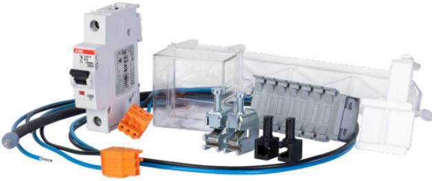
Absicherungspaket TIEHZ. Besthet aus: 1x LS-Schalter B6A 1-polig 25kA, 2x SSK16, Steuerleitungsklemme 7-polig, kurzschlussfeste Leitung 4 mm<sup>2</sup>, L-N Verdr. bis VNB + APZ-Raum, Kunststoffhutschiene.
