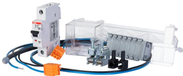
Absicherungspaket TIEHZ. Besthet aus: 1x LS-Schalter B6A 1-polig 25kA, 2x SSK16, Steuerleitungsklemme 7-polig, kurzschlussfeste Leitung 4 mm<sup>2</sup>, L-N Verdr. bis VNB + APZ-Raum, Kunststoffhutschiene.
