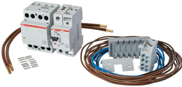
Verdrahtungspaket Wärmepumpe 63A, WP63R-Set. Besthet aus: Schütz 63A 4-polig, Plombierkappe, LS-Schalter 6A 1-polig 10 kA, Relais 20A,20-11, Steuerleitungsklemme, HLAK 25mm<sup>2</sup> 1-polig grau, inklusive Verdrahtungssatz.
