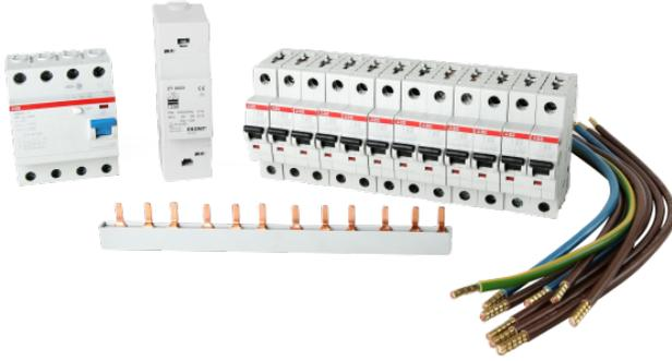
Verdrahtungspaket VB-Set. Besteht aus: 12x LS B16A1-polig, 1x Fi40 / 0,03A, 1x Klingeltrafo, 1x Phasenschiene, Verdrahtung.
