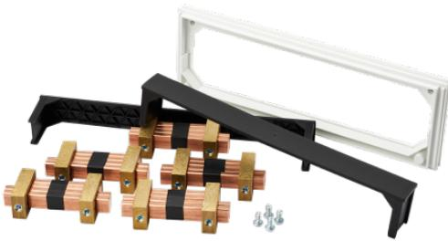
Sammelschienenverbinder, Schrank-Schrank-Verbindung, 5-polig, CU 12x10mm, Nennstrom 315A.
